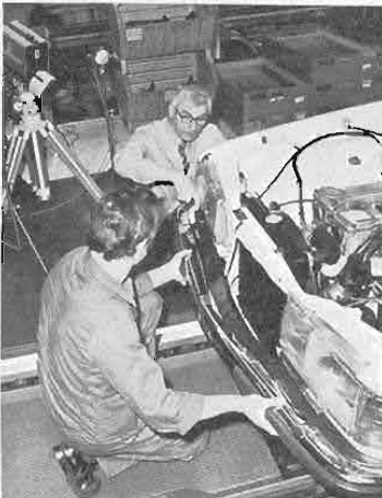
Bild 2 In den Fällen, in denen die Arbeitsmittel band- beziehungsweise ortsgebundene Spezialwerkzeuge und Vorrichtungen sind, werden die Aufnahmen direkt am Band gemacht. Dies geschieht bei stehendem Band (Arbeitspausen, vor oder nach der Schicht).
